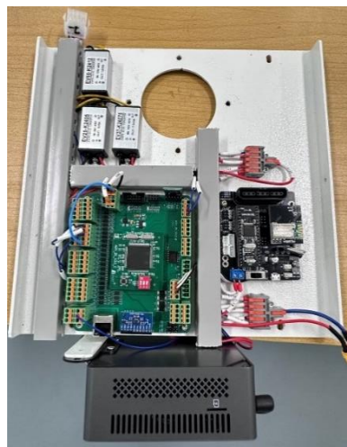
图 5 运动控制模块安装
