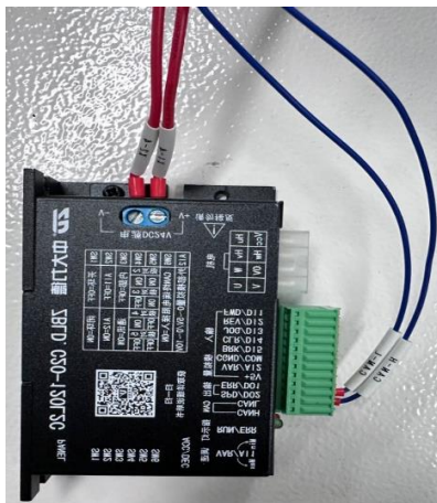
图 8 电机驱动器连线图
