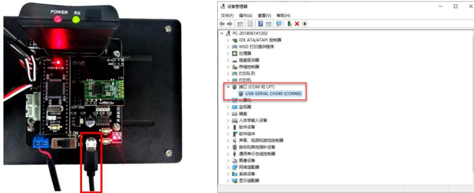
图 34 车载机械臂控制板下载口连接及 COM 端口设置
